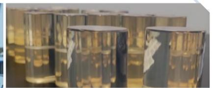
中国建材总院北分石英所研制的低渗氮耐辐照高纯石英玻璃首次应用于嫦娥六号上升器激光陀螺仪。
