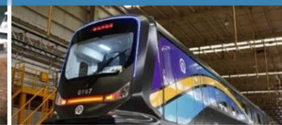
2024年6月26日，全球首列用于商业化运营的碳纤维地铁列车“CETROVO 1.0 碳星快轨”正式发布。中国建材总院哈玻院凭借先进的RTM工艺技术为该列车的成功运营提供了坚实的技术保障，中复神鹰T700级碳纤维成为该车承载结构—转向架横梁的主要材料，用新技术、新材料为助力列车实现轻量化赋能，共同引领地铁列车实现全新绿色升级。
