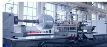
哈玻院自主研发生产的大尺寸、多开口推进分系统主承力薄壁加筋截锥，为“神舟”系列载人飞船贡献智慧。
