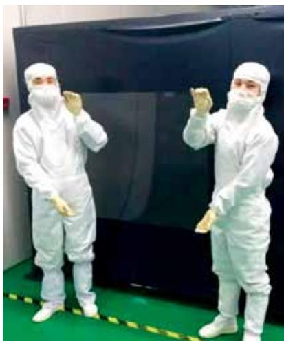
国内首片0.1mmTFT-LCD超薄玻璃基板
