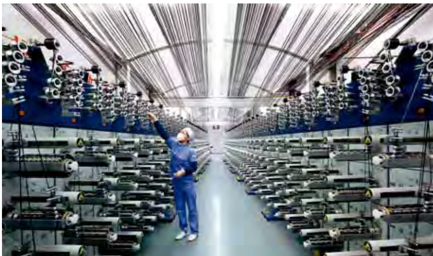
自主研发的T800级碳纤维生产线
